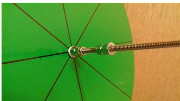
С помощью шпильки и гаек скрепите между собой три круга, подставку и стрелку ( расстояние между кругами 5-7 см).
